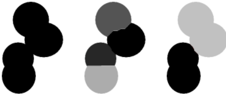
Abb. 11: Original (links), Trennung von Objekten mit Trennschärfe 1,0 (mitte) und mit Trennschärfe 0,9 (rechts).
